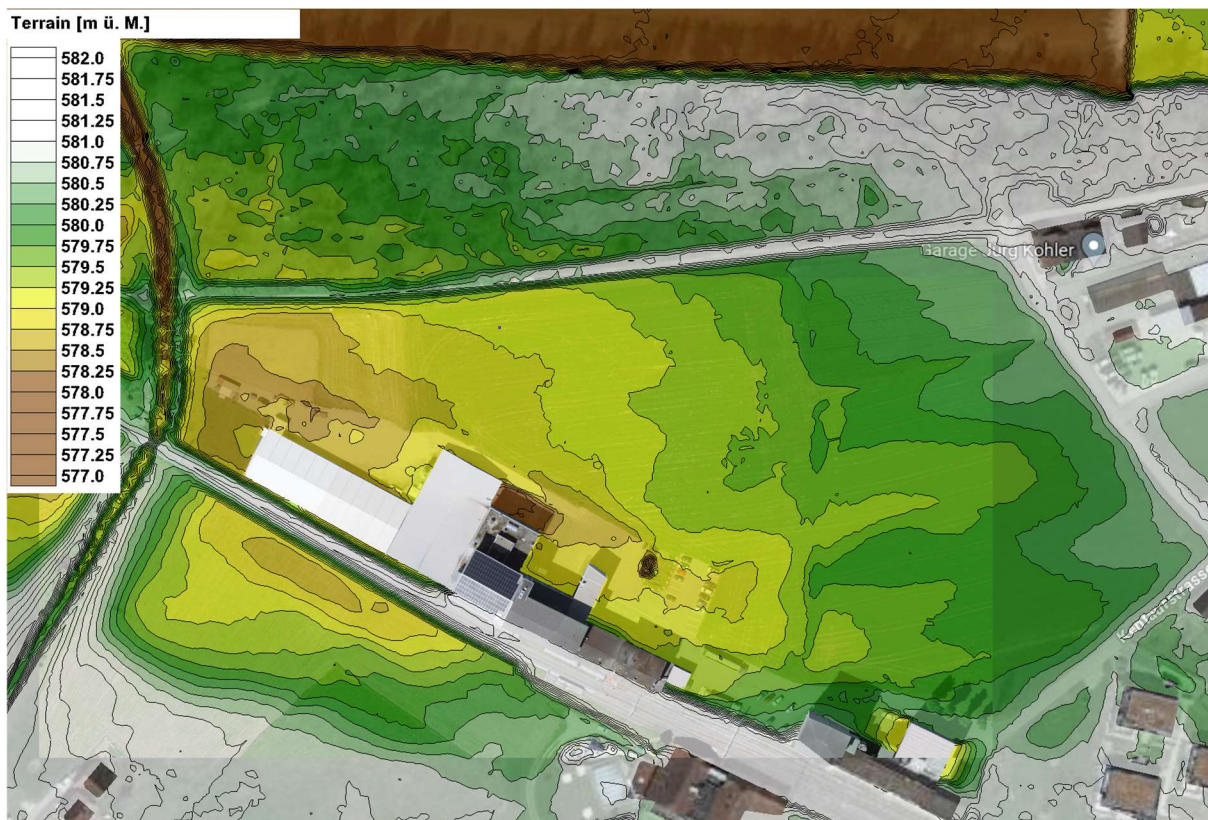
Abb. 3: Terrainkoten aus dem digitalen Terrainmodell. Die Äquidistanz der Höhenlinien beträgt 0.25 m.
