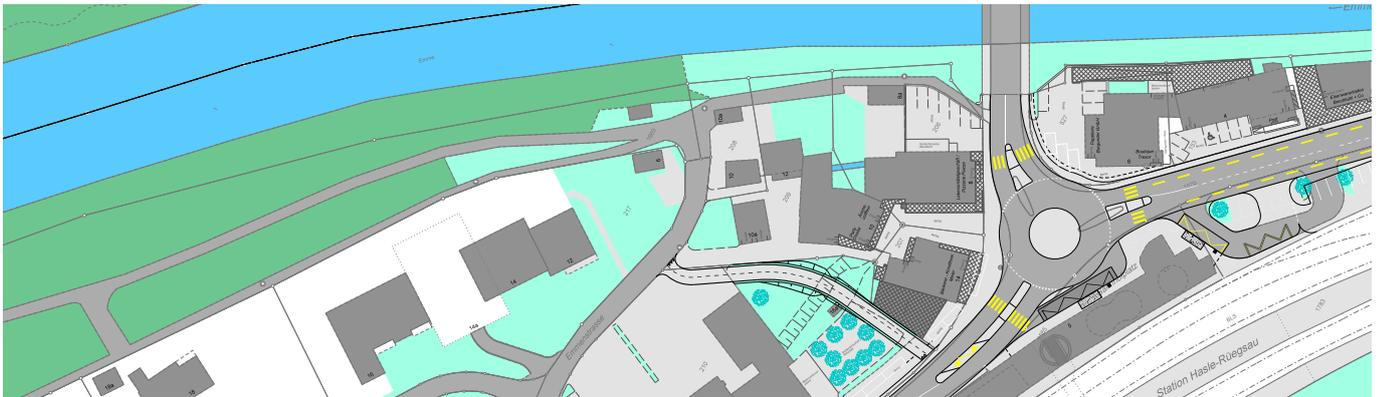
Knoten Kalchofenstrasse–Rüeegsastrasse: Die Abzweigung nach Rüeegsau wird zu einem Kreisverkehr umgestaltet.
